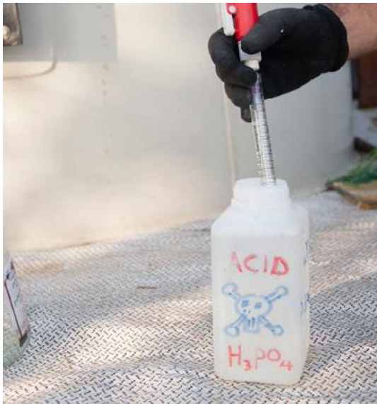
Fig. 3.11 - Acido fosforico, usato per abbassare il pH
