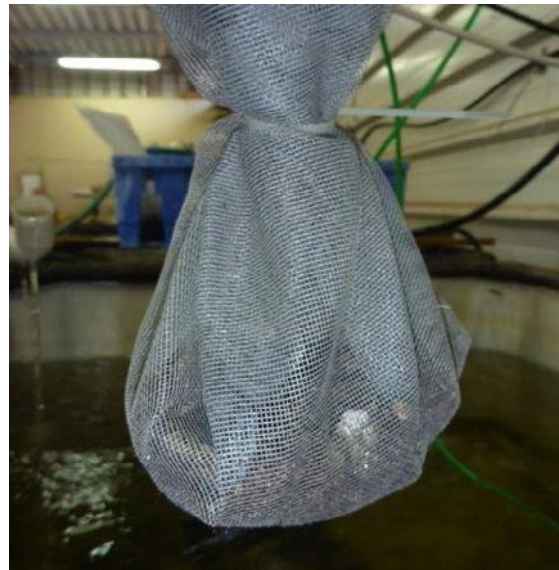
Fig. 3.12 - Aggiunta di conchiglie in un sacchetto di rete per liberare carbonato
